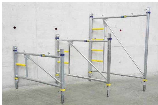
Ramele robuste, cu conectori integrați și inele de ridicare, sunt disponibile la înălțimile de 0,90m, 1,20m, 1,80m.
