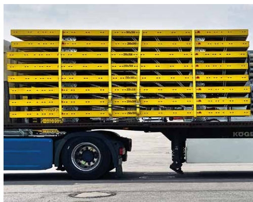
Coûts de transport fortement réduits grâce à une hauteur d'empilage réduite : jusqu'à 520 m 3 /camion
