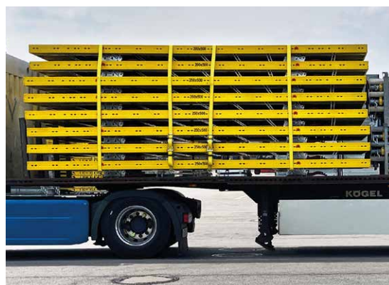
Stærkt reducerede transportomkostninger på grund af den lave konstruktionshøjde med op til 520 m 2 /lastbil
