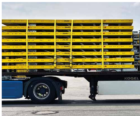
Znacznie obniżone koszty transportu dzięki niewielkiej wysokości całkowitej do 520 mm/pojazd ciężarowy
