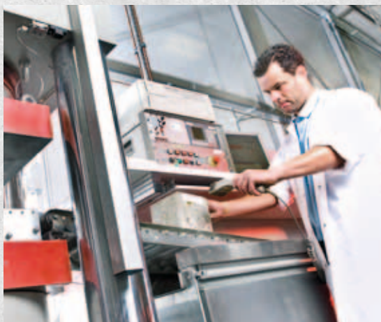
Badanie próbki betonu na ściskanie
