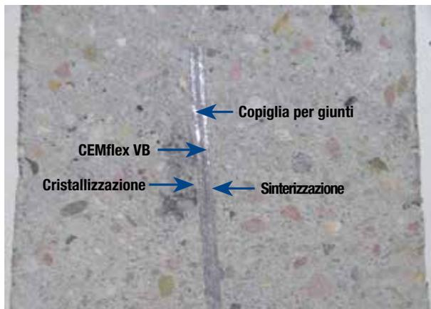
L'area di sovrapposizione del CEMflex VB (solo 5 cm) si sigilla automaticamente in caso di penetrazione d'acqua. Questo processo avviene con estrema rapidità, cioè in poche ore (cristallizzazione attiva + sinterizzazione attiva).
