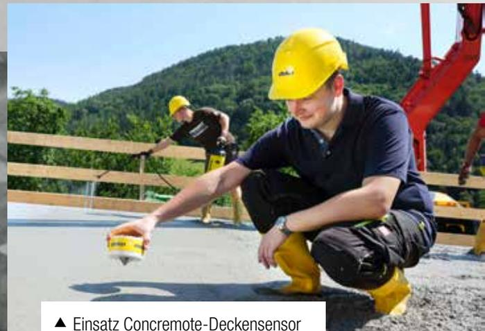
▲ Einsatz Concremote-Deckensensor
