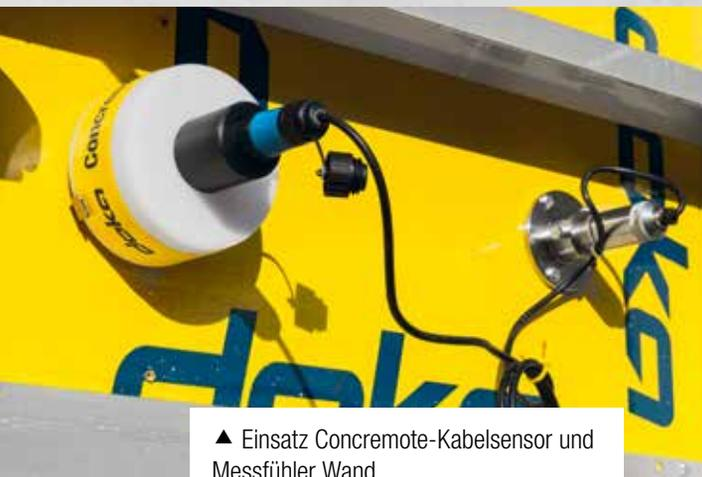
▲ Einsatz Concremote-Kabelsensor und Messfühler Wand
