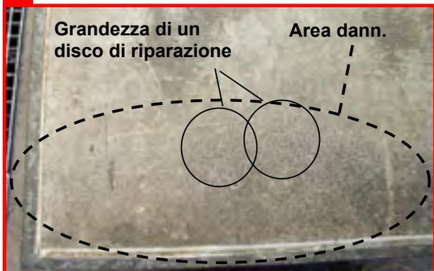
• ammessi un max. di 2 dischi di riparazione D60
