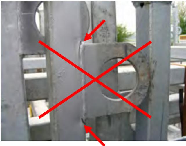
Generalmente non consentite per attacchi di gru, strutture portanti, ponteggi e impalcature di protezione. Altrimenti consentite fino a max. 5mm.
