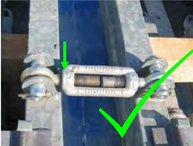
Una volta montati, devono avere lo stesso senso di rotazione.
