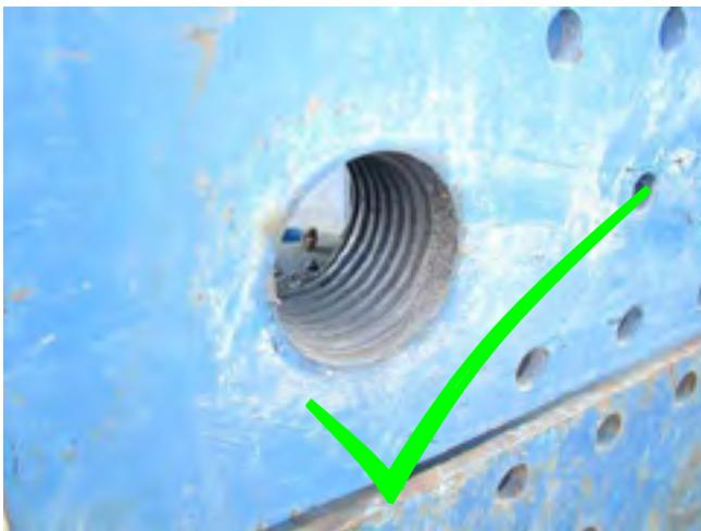
Esempio: filettatura del telaio di montaggio
