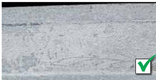
**Les résidus de béton sous forme de film jusqu'à 1 mm sont acceptés.**
