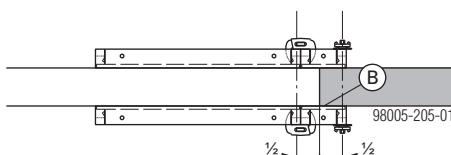
**B** Уплотнительная лента с обеих сторон (см. главу "Герметизация вертикальных швов")
