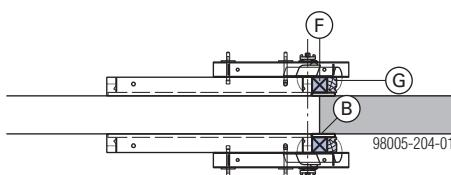
Пример 3: Узкий элемент в зоне стыка между захватками
