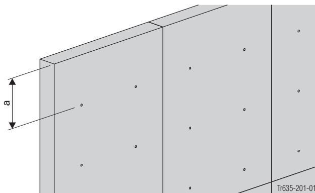
а ... макс. 80 см для точек подвеса, которые создаются с помощью закладного фиксатора для лицевого бетона 15,0 5см.
