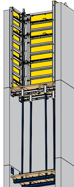
Die perfekte Kombination für Schächte: Schachtbühne und Framax-Ausschalecke I. Das Ein- und Ausschalen erfolgt ohne Kran durch einfaches Spindeln mit einem Hammer, Bewehrungsseisen oder mit der komfortablen Ratsche.
