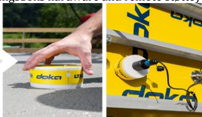
Følere plasseres direkte i den ferske betongen før eller under støping.
