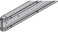
покрытие желтого цвета<br>допуст. изгибающий момент: 5,0 кНм<br>Допуст. поперечное усилие: 11,0 кН<br>В соответствии с допуском Института строительной техники, г. Берлин. Данные значения действительны только для применения опалубочных балок в вертикальном положении. |      |           |
