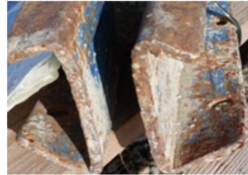
Megcsavarodott és eldeformálódott > 5 mm
