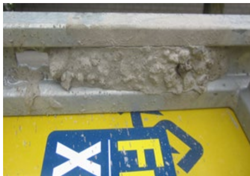
A keretprofil belseje tele van betonnal
