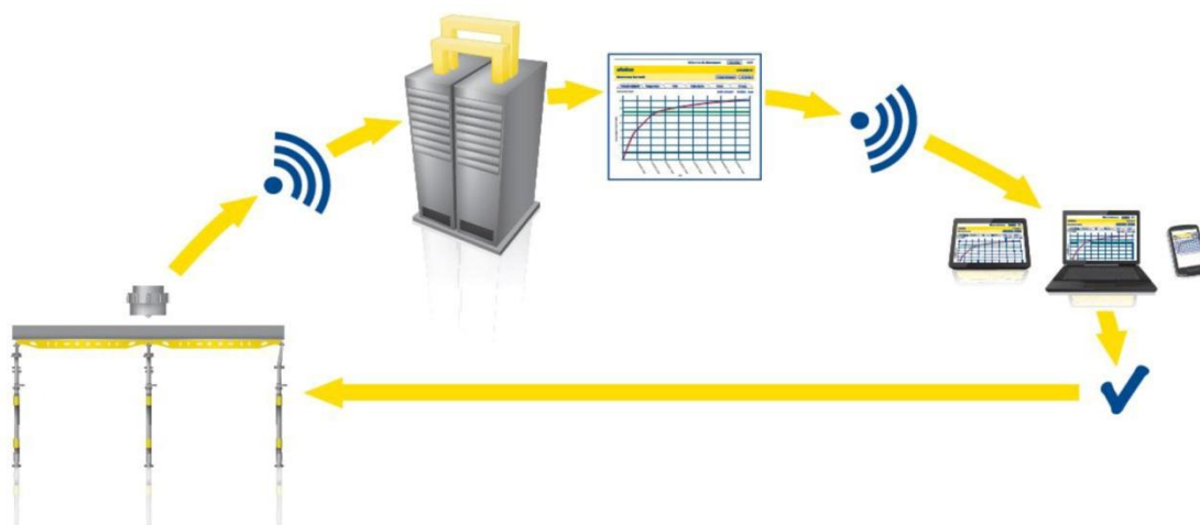
Obr. 3: Systém monitorovania betónu
