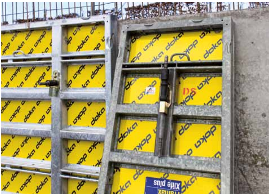
▲ Zum Umsetzen lässt sich der Framax Xlife plus-Anker direkt an der Ankerhülse in der Distanzsicherung parken.
