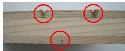
Obr. 4 Nesprávne otočenie krycích vrstiev dosky – časté a veľké trhliny na povrchu dosky
