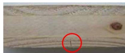
Obr. 3 Správne otočenie krycích vrstiev dosky – žiadne alebo malé trhliny na povrchu dosky
