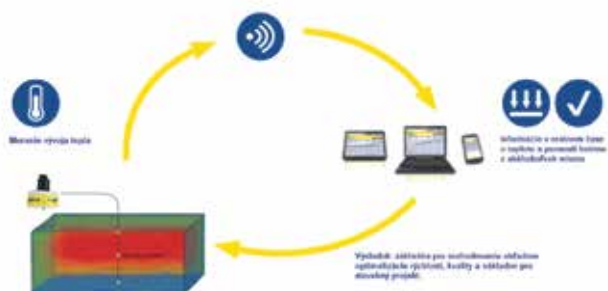
Schéma zapojenia systému Concremote
