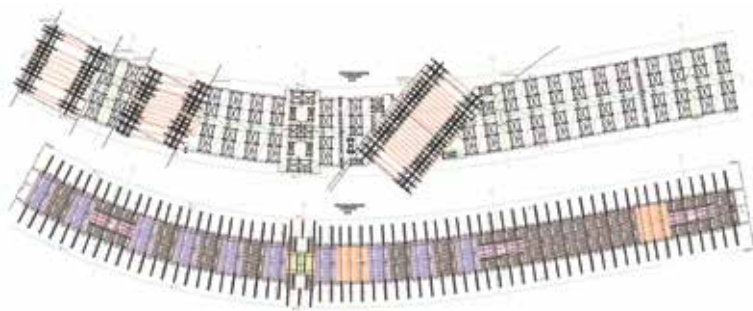
Schéma 1: Pôdorys rozmiestnenia podpernej skruže Staxo 100 a debnenie spodnej dosky mostovky – 1. etapa
