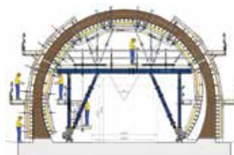
4 Tunelový systém DokaCC je prispôbitelný na pravouhlý, ako aj kruhový prierez tunelového objektu
