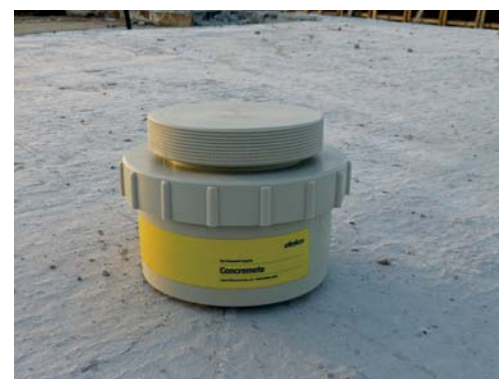
▲ Concremote – он-лайн контроль набора прочности бетона.
