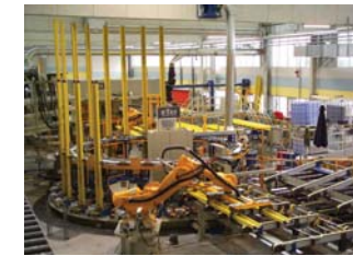
▲ производство балки H20 top с эффективными защитными наконечниками.
