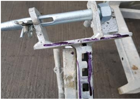
Verbindingsdeel met beugel gebroken/gebogen
