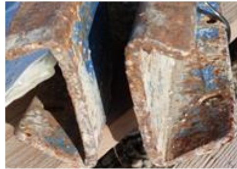
Verdraaid en vervormd > 5mm
