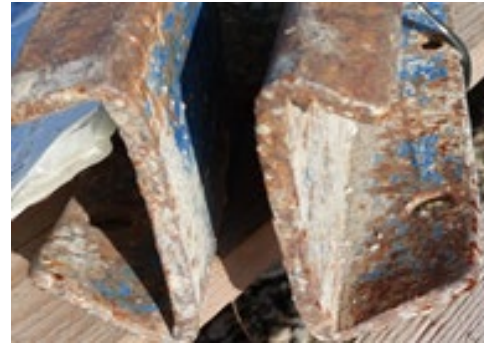
Verdraaid en vervormd > 5mm
