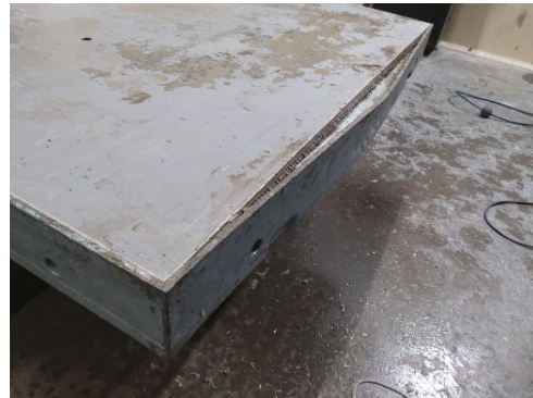
Frame profiel gebogen >2mm
