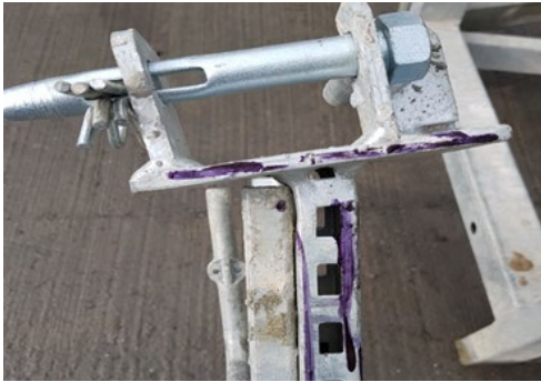
Verbindingsonderdeel met beugel gebroken/gebogen
