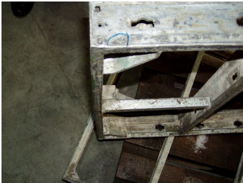
Frame profiel gebogen >2mm
