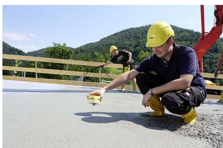
Concremate, système numérique de mesure et de prise de décision qui détermine la résistance du béton sur place en temps réel, propose de nouvelles fonctions avec la génération de capteurs 2.0.
