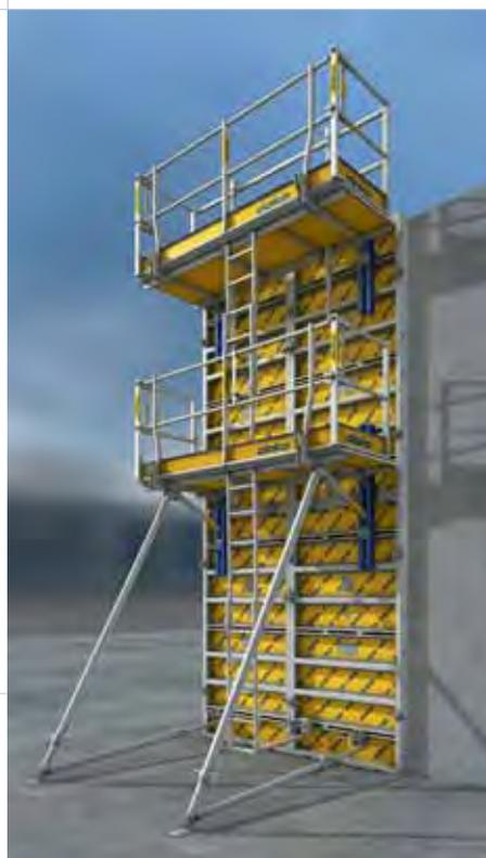
Doka amplia la gamma di accessori per la sicurezza con il sistema di passerelle Xsafe, compatibile con tutti i sistemi Doka per pareti. E' premontato, e quindi riduce del 30% il tempo di lavoro rispetto ai sistemi di passerelle tradizionali. Xsafe plus e la cassaforma possono essere traslati sempre come unità, con un unico tiro di gru. Questa significa che Xsafe plus viene impiegato più rapidamente del 40% rispetto ai sistemi tradizionali.
