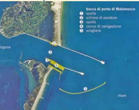
▲ Schema della Bocca di porto di Malamocco
