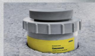
Le capteur pour les dalles est placé sur la surface du béton frais après lissage.
