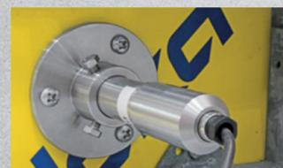
La sonde du capteur à câble est directement installée sur la peau coffrante et se translate avec le coffrage.
