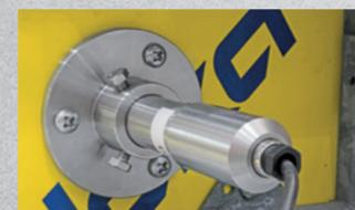
La sonda del sensore con cavo viene montata direttamente sulla cassaforma e movimentata assieme alla stessa.
