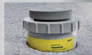
Il sensore per solai viene collocato sulla superficie del calcestruzzo fresco dopo la sua lisciatura.
