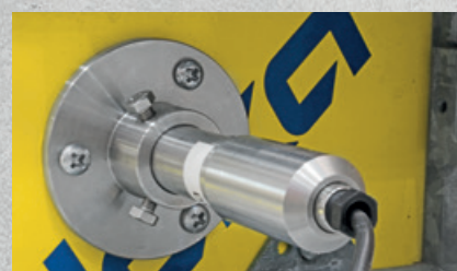
De wandsensor wordt direct aan de bekisting gemonteerd en samen met de bekisting verplaatst.
