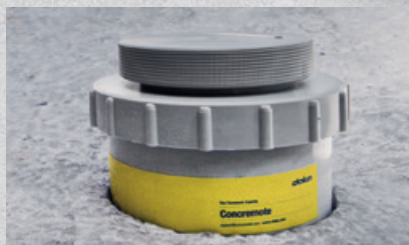
De vloersensor wordt na het afstrijken van het beton op het verse betonoppervlak geplaatst.
