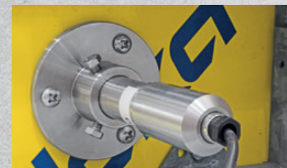
De wandsensor wordt direct aan de bekisting gemonteerd en samen met de bekisting verplaatst.
