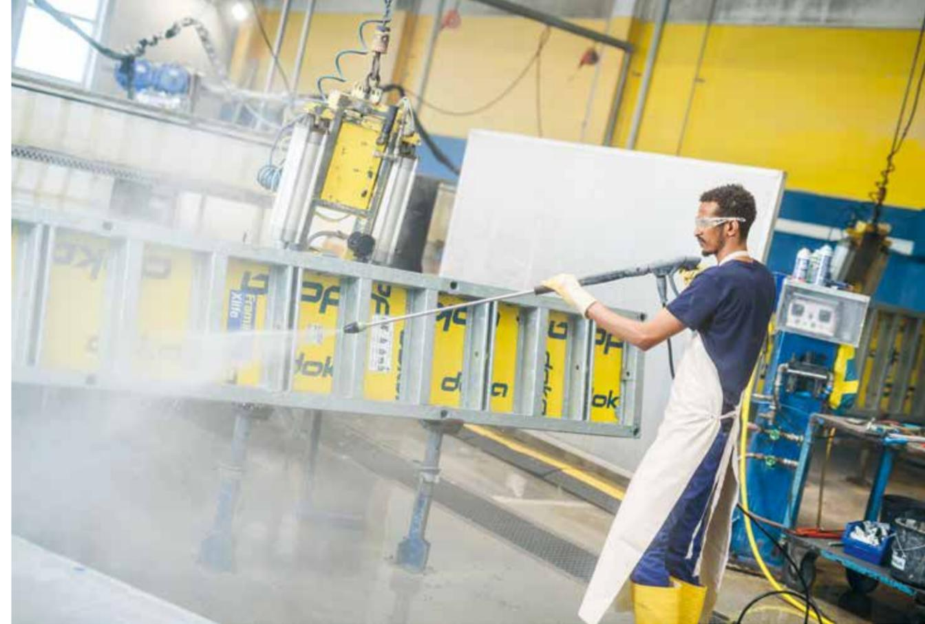
Eigene Reinigungsstrecken für Rahmenschalungen wie hier in Stetten bei Wien (Österreich) reduzieren die Reinigungsdauer erheblich und machen die Schalungen wieder schneller fit für den nächsten Baustelleneinsatz.
