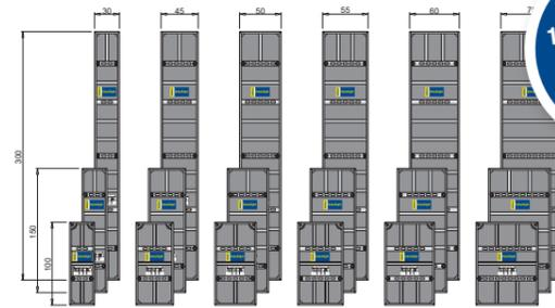
Einfache Anpassung an das Bauwerk durch logischen Elementraster von 15 cm
