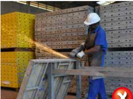
No limpiar estructura del panel con esmeril angular.
