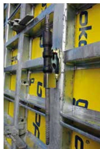
▲ Pohľad na jednostranne ovládateľnú kotvu Framax Xlife plus v parkovacej polohe – vždy poruke.
