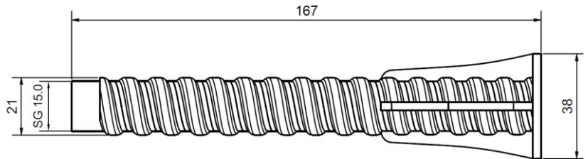
Verlorenes Ankerteil zur einseitigen Verankerung folgender Systeme mittels Ankerstab 15,0:
