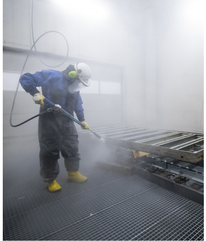
Die professionelle Reinigung erfolgt durch den Doka-Geräteservice in einer top-modernen Wasch- und Reinigungsanlage.
