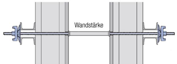
Schnittlänge FB-Rohr = Wandstärke - 2x Dichtungskappe
