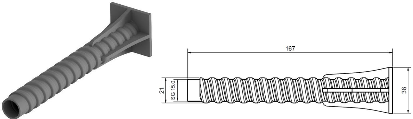
Verlorenes Ankerteil zur einseitigen Verankerung folgender Systeme mittels Ankerstab 15,0:
